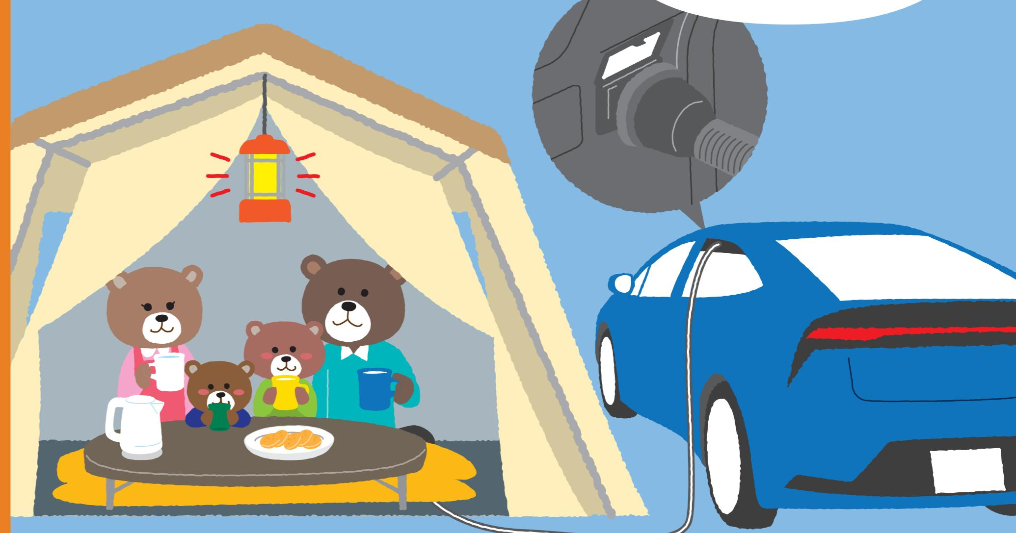
\*1 アクセサリーコンセント(AC100V・1500W)設定車の場合。また電気製品の消費電力は一般的な目安です。製品の種類や大きさなどにより消費電力は大きく異なる場合があります。また、立ち上がり時などは瞬間に電力を大量に消費します。AC100Vで最大消費電力1500W以下の電気製品をご使用ください。ただし、電気製品によっては消費電力の合計が1500W以下の場合でも正常に作動しない場合があります。使用する電気製品の取扱書の注意事項に従ってご使用ください。一般的な電気製品の多くは自動車内や屋外での使用は想定されていないため、問題が発生する可能性があります。工場出荷時の電源周波数は車両によって異なります。車両の取扱説明書を確認し、電気製品の使用可能な周波数と車両の電源周波数が異なる場合は、販売店にご相談ください。\*2 クルマを地面が固く平らな場所に止め、かつ換気の良い環境でご使用ください。一部地域では、駐車または停車中にエンジンを始動させた場合、条例に触れるおそれがあります。関係する自治体に確認した上で、適切にご使用ください。
